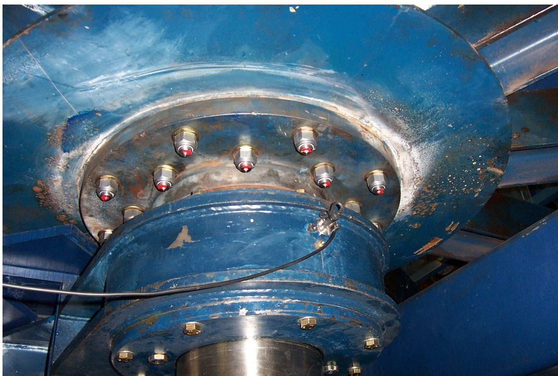
Palier supérieur de la poulie motrice de la TC du Chamois (Megève), et le capteur d'essai
