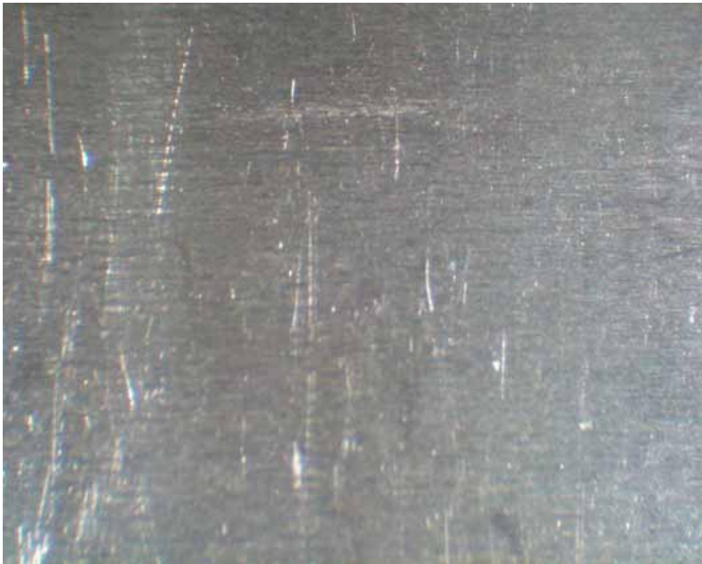
Rayures sur bague intérieure.
