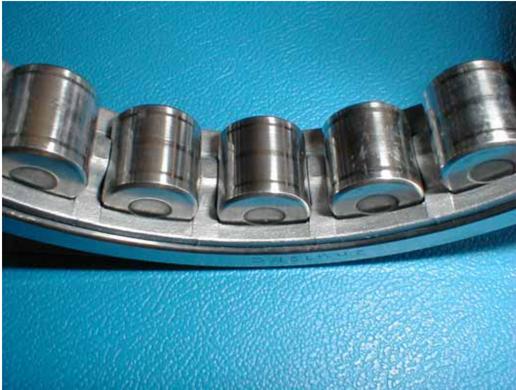
Cernes d'usure sur les rouleaux.
