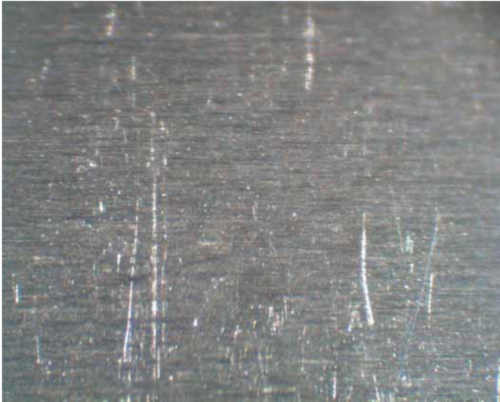
Rayures sur bague intérieure.
